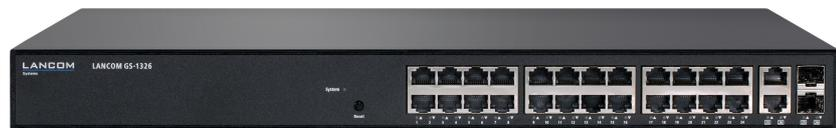
Der Websmart Switch LANCOM GS-1326 ist die ideale Wahl für Netzwerke in kleinen und mittleren Unternehmen. Für die Vernetzung von bis zu 26 Geräten überzeugt er durch sein optimales Preis- / Leistungsverhältnis. Er ist ausgestattet mit 24 Gigabit Ethernet-Ports und 2 Combo-Ports (Ethernet oder Glasfaser) sowie zahlreichen Sicherheitsfunktionen. Seine Bedienung erfolgt dabei über eine benutzerfreundliche Weboberfläche.
