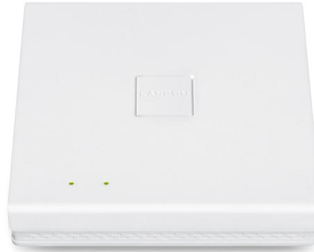
Eine moderne Funkinfrastruktur behält die Erweiterung um zukünftige Technologien im Blick. Dieser Access Point bietet neben schnellem 11ac Wave 1-WLAN (Wi-Fi 5) zusätzliche IoT-Readiness. Der integrierte USB-Port ermöglicht die einfache Einbindung unterstützter IoT-Module in die existierende WLAN-Infrastruktur. Unternehmen und der stationäre Einzelhandel profitieren durch diese flexiblen Anwendungsmöglichkeiten von einer leistungsstarken und erweiterbaren Funkinfrastruktur.
